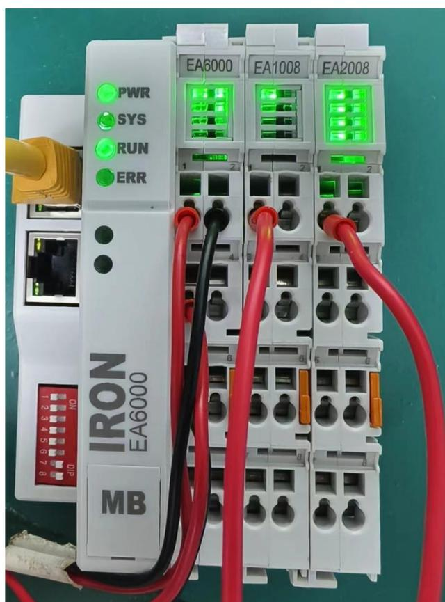
将 IO 模块输出通道接到 IO 模块输入，读数据如下图
