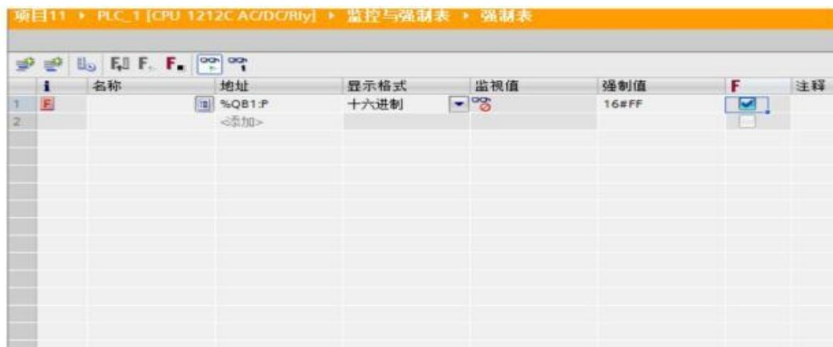
%QB 和%QW 表示输出，其中%QB 占一个字节，%QW 占两个字节；%IB 和%IW 表示输入，其中%IB 占一个字节， %IW 占两个字节
